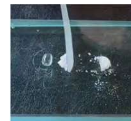
Passo 02 Incorporação do pó ao líquido para obtenção de uma mistura lisa e homogênea.
